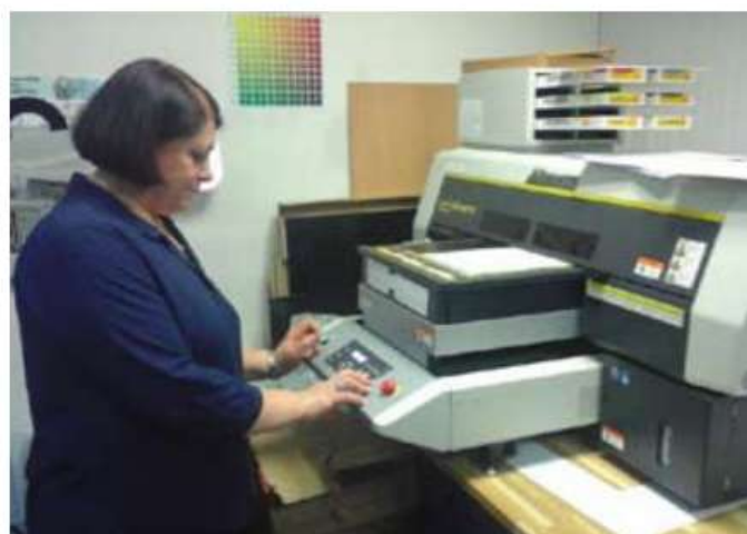
Dominique lance une impression numérique. Cette machine peut imprimer sur tout support rigide jusqu'à 50 millimètres d'épaisseur
